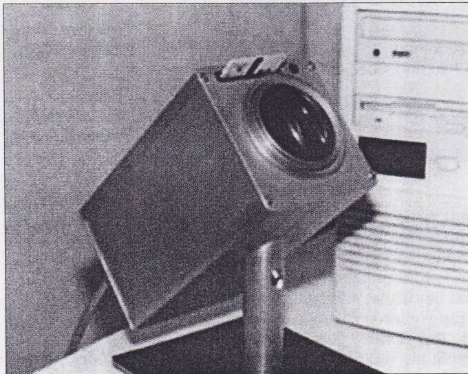
Bild 7. Die Kamera zur Erkennung des Fingerabdrucks mittels Ultraschall ist zur Zeit noch in der Prototyp-Phase.
