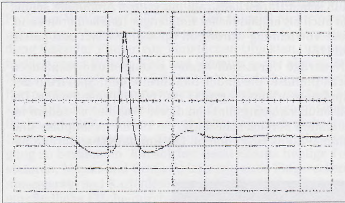
Bild 6. Die Impulsdauer des entwickelten Wandlers beträgt etwa 20 ns. Die Empfangsbandbreite liegt zwischen 4 und 25 MHz.
